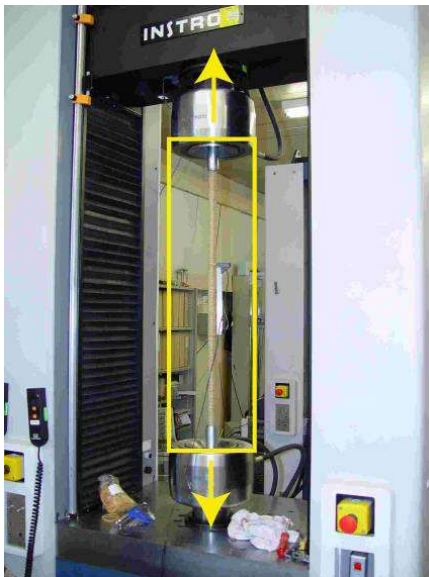
Tensile test on a FRP-rebar @ Empa
