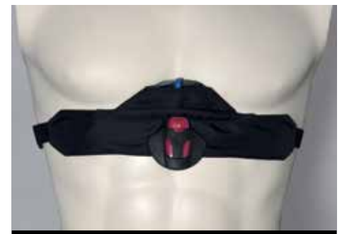
Der Prototyp des EKG-Brustgurts wurde in mehr als 100 Experimenten an verschiedenen Probanden getestet.
