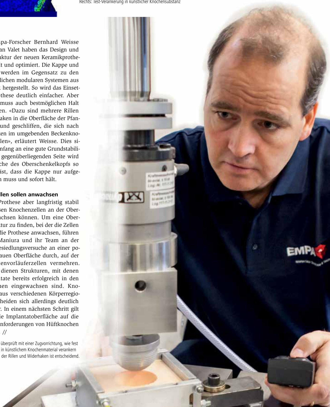
Links: Konstruktionschema einer Resurfacing-Prothese Mitte: Bauteile im Vergleich zu herkömmlicher Hüftprothese Rechts: Test-Verankerung in künstlicher Knochensubstanz
