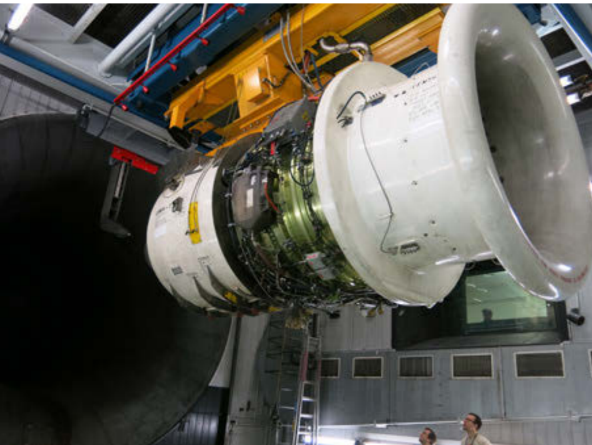
Boeing-737-Triebwerk im Teststand der SR Technics am Flughafen Zürich. 95 Stunden lang untersuchten Empa-Forscher die Emissionen beim Rollen, bei Start, Steigflug und Reiseflug.
