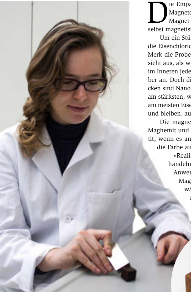
Vivian Merk demonstriert, dass der Holzwürfel tatsächlich am Magneten haftet.
