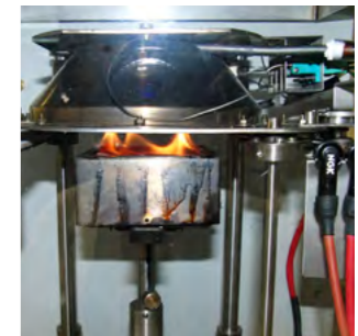
Flammversuch im Labor. Mit definiertem Abstand zur Flamme werden alle Proben getestet.
