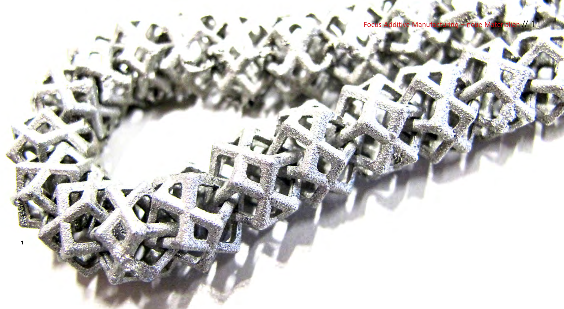
1 Eine Kette, fabriziert im Additive-Manufacturing-Verfahren (AM): Die Kettenglieder sind ineinander gefügt und dennoch in einem Stück gefertigt. Design und Herstellung: La Manufacture CSC.
