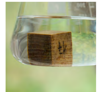
Ein mehrstündiges Bad in der Ester-Lösung sorgt für eine Durchtränkung bis in die Zellen.
